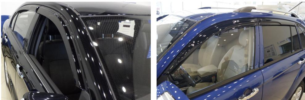
Дефлекторы на окна обеспечивают постоянный приток свежего воздуха, не допуская запотевания и попадания в салон воды во время дождя, пыли во время засухи, посторонних предметов после выбрасывания их из впереди идущих автомобилей. Также они служат для оптимизации распределения воздушных потоков, что позволяет ехать с открытыми окнами на любой скорости.
