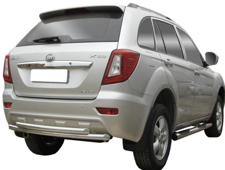
Защита заднего бампера представляет собой прямую или изогнутую трубу, которую устанавливают по всей длине заднего бампера, либо два уголка из полированной металлической трубы, которые монтируют по его углам.
