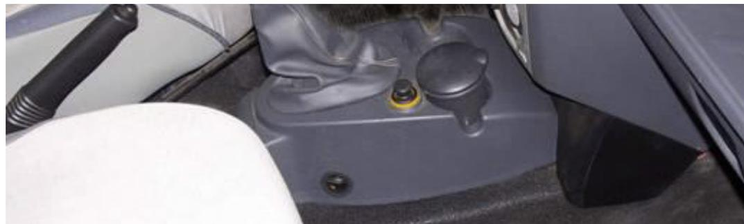
Следует подчеркнуть, что главным конструктивным преимуществом механического блокиратора является скрытность и недоступность всех его элементов, снаружи видны лишь личинка замка и отверстие для блокирующего устройства.
