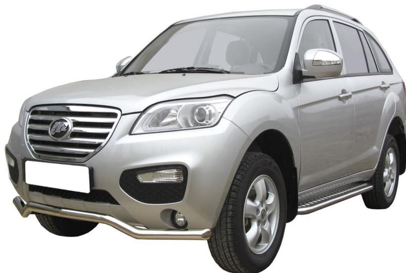
Обвес для внедорожников делится на две группы – кенгурятники и защитные трубы, так называемые СитиГарды (CityGuard). Крепление осуществляется в штатные места, изначально предусмотренные производителем, лонжеронах или переднем усилителе бампера. Если установлена низкая защита бампера (CityGuard), то независимо от того, выступает она за габариты авто или нет в ГИБДД к Вам вопросов не возникнет и Вы спокойно сможете пройти ТО или совершить регистрационные действия.
