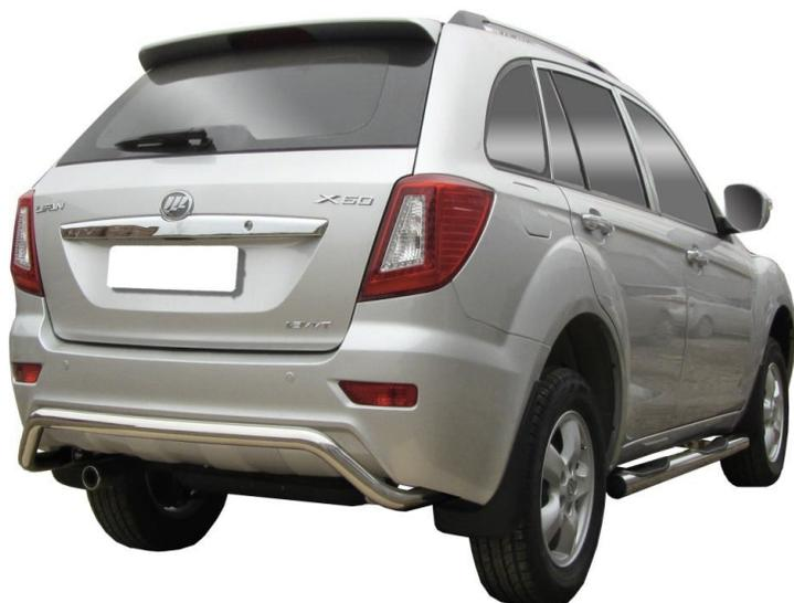
Стильная и эффективная конструкция из стальных труб, которая предохраняет задний бампер от повреждений в случае неудачной парковки, езды по пересечённой местности, ударов.
