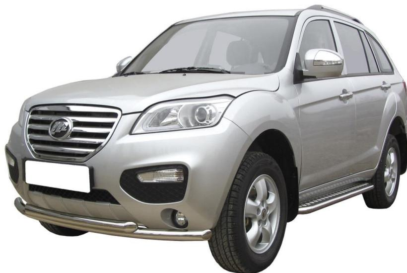
Самая популярная низкая защита бампера – модель состоящая из двух параллельных труб, верхняя из которых тоньше и короче низких.
